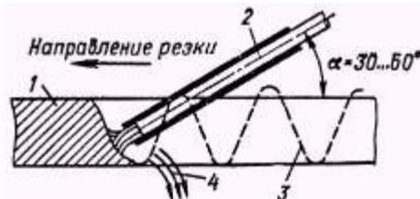
Рис. 3.89. Дуговая резка металлическим электродом: 1 - разрезаемый металл; 2 - металлический электрод с покрытием; 3 - траектория движения конца электрода; 4 - вытекающий жидкий металл
