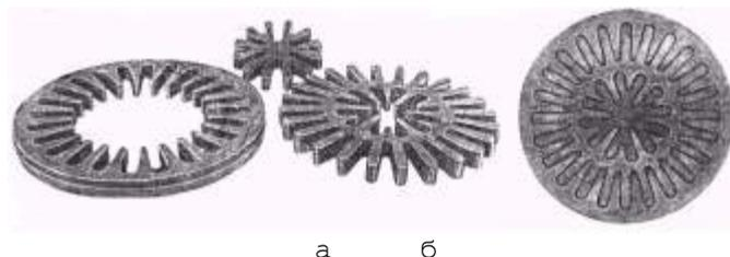
Рис.3.88. а - детали магнитной плиты, вырезанные газокислородной резкой по копиру из одного листа в три прохода; б - детали плиты в сборе
