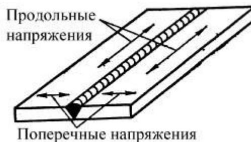
Рис.1.12. Направления действия продольных и поперечных внутренних напряжений
