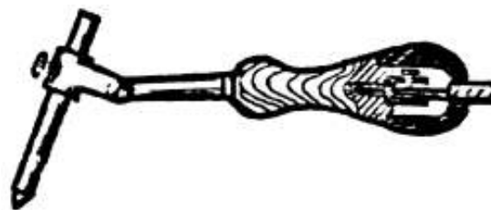
Рис. 1.4. Держатель Н.Н. Бенардоса для ручной дуговой сварки угольным электродом
