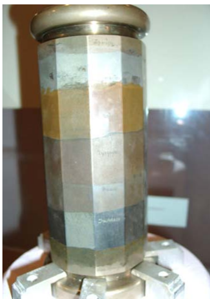
Рис. 1.5. Знаменитый многослойный стакан Н.Г. Славянова, изготовленный методом электрической отливки
